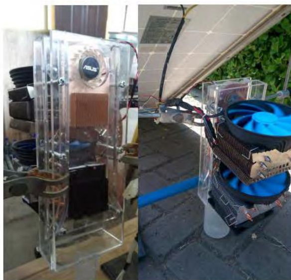
شکل (۱): تولید آب با استفاده از ترموالکتریک
